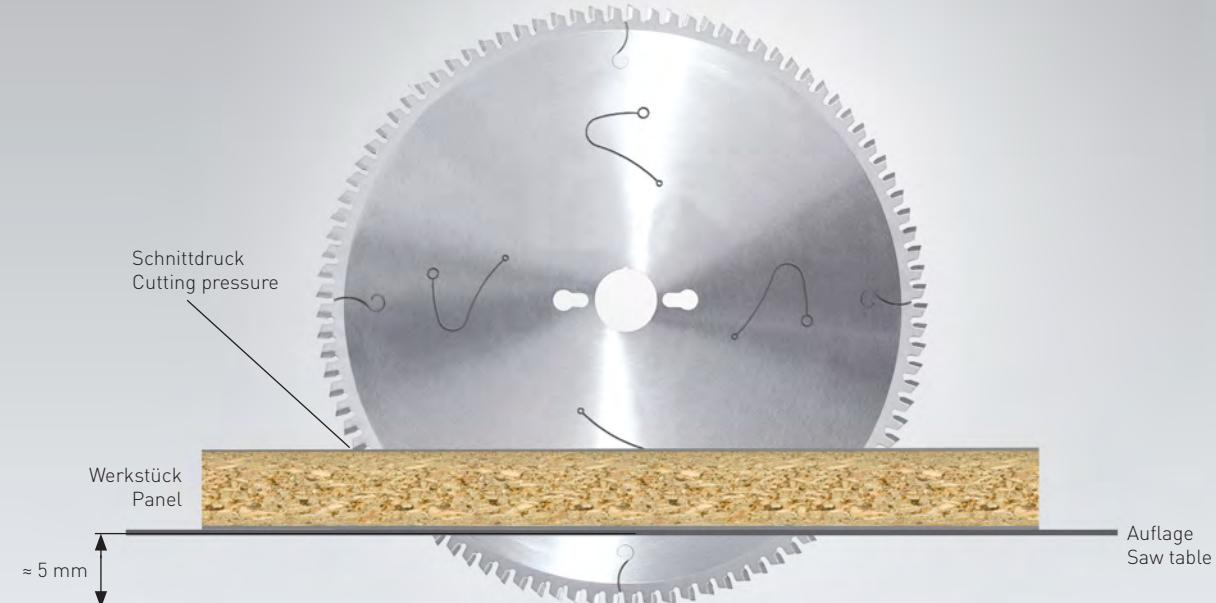
Durch den negativen Spanwinkel wirkt der Schnittdruck über dem Werkstück auf die stabile Tischauflage.
